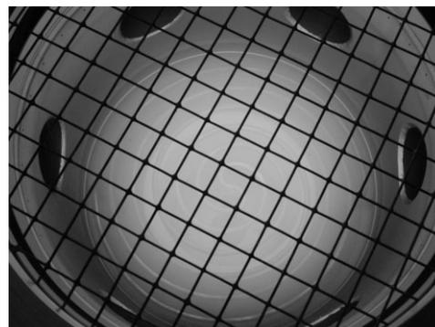
**Abbildung 1.** Charakteristisches Leuchten eines Argon-Plasmas. Dieses Phänomen beruht auf der Abgabe von Energie in Form von Strahlung unterschiedlicher Wellenlänge, die bei der spontanen Emission angeregter Atome und Moleküle freigesetzt wird.
